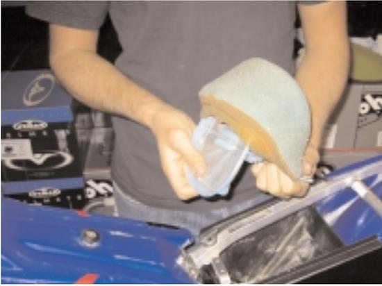
Den verschmutzten Luftfilter ausbauen und vom Luftfiltergitter nehmen.
