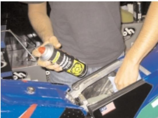
Bei starker Verschmutzung des Luftfilterkastens zuerst mit Lappen und Brakecleaner ausreiben.
