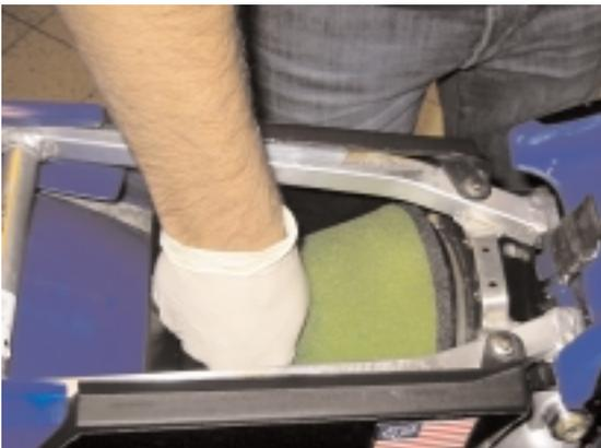
Den Filter wieder auf das Gitter / Käfig aufziehen und anschliessend wieder einbauen. Darauf achten dass der Filter sauber sitzt. Die Dichtheit mit den Fingern kontrollieren.
