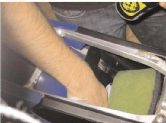
Das Luftfilteröl das im Kasten oder Rahmen hängen geblieben ist, mit Reiniger und Lappen abputzen, damit kein Staub hängen bleibt. Sitzbank drauf und ab geht's.
