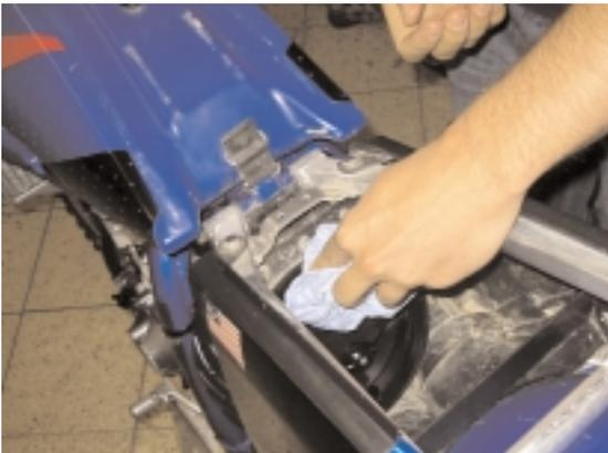
Den Ansaugstutzen und die Dichtfläche des Kastens säubern.
