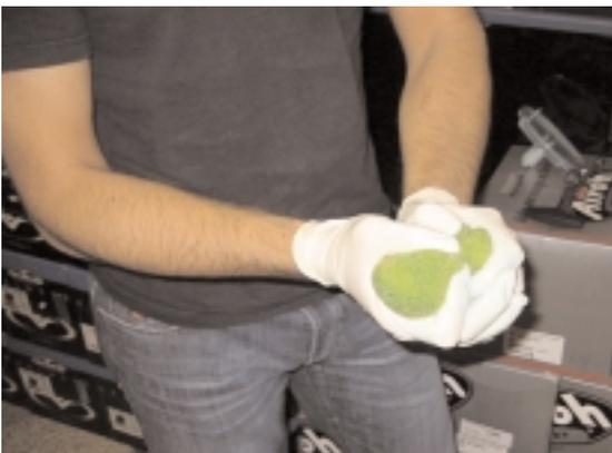
Das Luftfilteröl durch gleichmäßiges drücken (kneten) verteilen.
